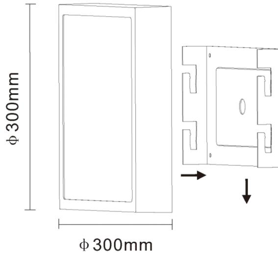
Plafonnier/mural carré en aluminium IP40 avec température de couleur réglable 2700/3000/4000K. Équipé de puces LED SMD2835 CRI>90 de Bridgelux avec une efficacité jusqu'à 130lm/W.
