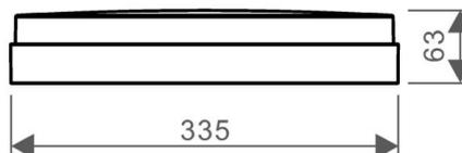
Luminaire ronde pour plafond/mur dans un boîtier en polycarbonate IP54 IK10. Puissance réglables 6/12W et température de couleur réglables 3000/4000/5000K. Equipé de SMD2835 avec une efficacité jusqu'à 110lm/W.
