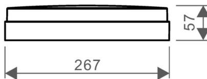
Luminaire ronde pour plafond/mur dans un boîtier en polycarbonate IP54 IK10. Puissance réglables 6/12W et température de couleur réglables 3000/4000/5000K. Equipé de SMD2835 avec une efficacité jusqu'à 110lm/W.
