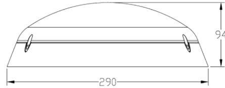
Luminaire robuste et étanche pour montage plafond-mur IK10 IP65. Avec unité de secours 3h 1,5W.
