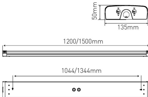
Luminaires de plafond IP44 avec câblage traversant 5x2,5mm<sup>2</sup> pour un éclairage uniforme des couloirs. Puissance réglable 22/28/34/39W et température de couleur réglable 3000 ou 4000K.
