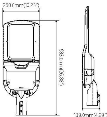
Luminaire sur poteau en aluminium IP66 IK08 gris RAL9006 avec lentille type 4 86x143gr. Convient pour une fixation horizontale ou verticale sur poteau de 60 mm. Garantie de 7 ans.
