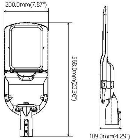
Luminaire sur poteau en aluminium IP66 IK08 gris RAL9006 avec lentille type 4 86x143gr. Convient pour une fixation horizontale ou verticale sur poteau de 60 mm. Garantie de 7 ans.
