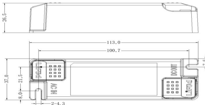
Driver LED pour panneau LED 24W courant constant 40VDC 600mA
