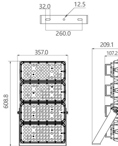
Power floodlight avec revêtement gris RAL7044. Puces LED EMC5050 avec une efficacité jusqu'à 170 lm/W. Driver avec fonction CLO et protection contre les surtensions de 10 kV.
