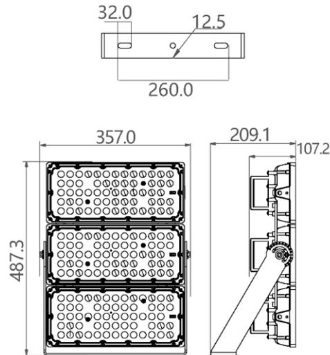
Power floodlight avec revêtement gris RAL7044. Puces LED EMC5050 avec une efficacité jusqu'à 170 lm/W. Driver avec fonction CLO et protection contre les surtensions de 10 kV.
