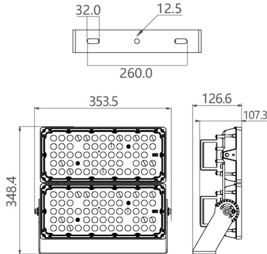
Power floodlight avec revêtement gris RAL7044. Puces LED EMC5050 avec une efficacité jusqu'à 170 lm/W. Driver avec fonction CLO et protection contre les surtensions de 10 kV.
