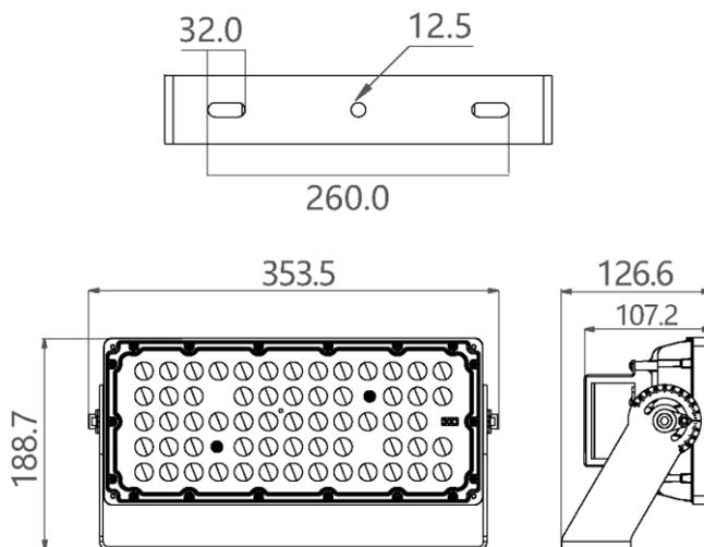
Power floodlight avec revêtement gris RAL7044. Puces LED EMC5050 avec une efficacité jusqu'à 170 lm/W. Driver avec fonction CLO et protection contre les surtensions de 10 kV.
