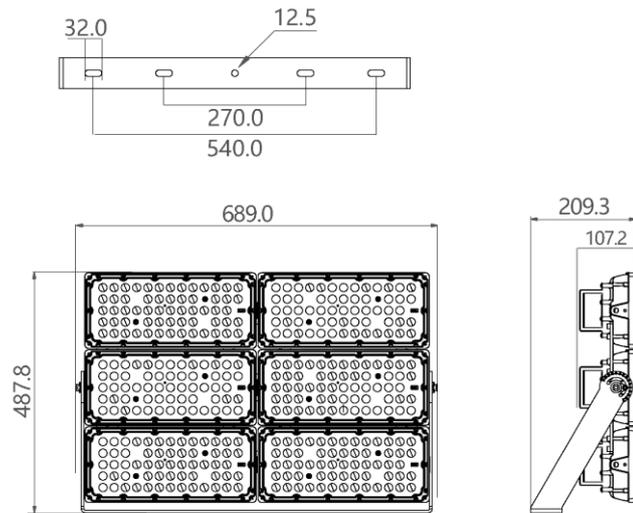
Power floodlight avec revêtement gris RAL7044. Puces LED EMC5050 avec une efficacité jusqu'à 170 lm/W. Driver avec fonction CLO et protection contre les surtensions de 10 kV.
