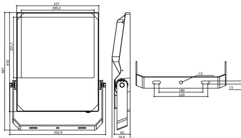
Projecteur LED Beam équipé de puces LED à haute efficacité de Lumileds. Le boîtier IP66 à revêtement en poudre noire RAL9017 est équipé d'une verre facetté IK08.
