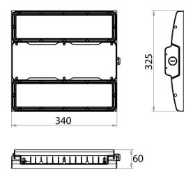
Highbay linéaire de grande hauteur ballproof conforme norme DIN 18032-3, montage apparent ou suspendu.
